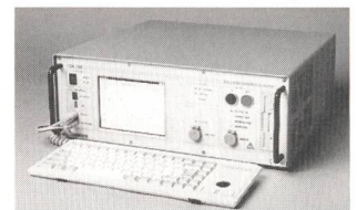
IDA 200, ein neues Konzept für die Diagnose der Isolierung von Leistungstransformatoren
