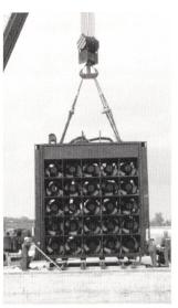
25 Kleinturbinen, angeordnet in einer 5x5-Matrix.
