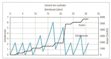
Bild 5 Entwicklung der Schadensrate bei einem Peltonlaufrad.
