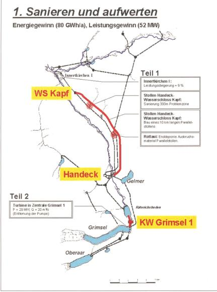
Bild 1 Sanieren und aufwerten.
