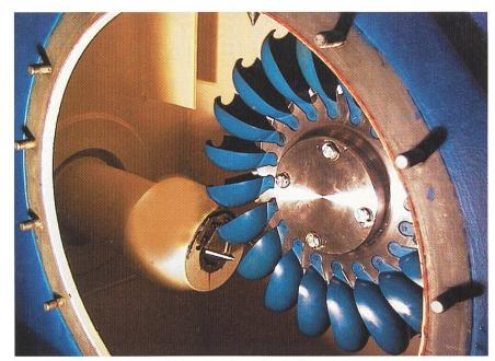
Bild 4 FiberGuss<sup>TM</sup>-Becher aus kohlefaserverstärktem Kunststoff, verankert in einer Stahlscheibe (Foto von einer Inspektion nach 15 000 Betriebsstunden).
