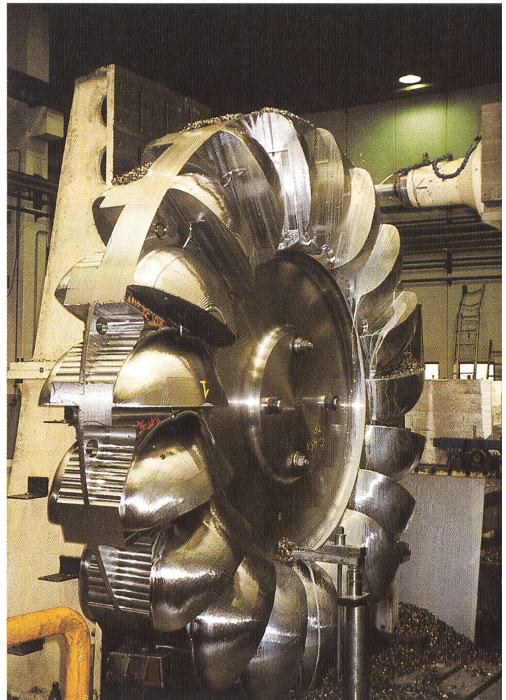
Bild 1 Peltonrad aus geschmiedeter Scheibe, aus der die Becher mit hoher Präzision gefräst wurden (CNC-Fräsarbeiten).
