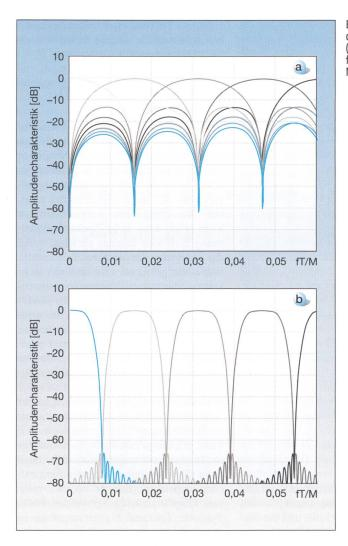
Bild 5 Teilkanalfrequenzsignale von DMT (a) und FMT (b) für f∈ [0, 0,06 M/T] und M = 64
