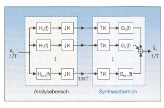
Bild 2 M-Teilband-Generalisierung des Quadraturspiegelfilters (QMF). Subsampling (↓K) und Upsampling (↑K) um einen Faktor K
