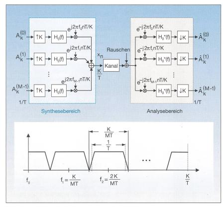
Bild 3 Kommunikationssystem mit Filterbankmodulation
