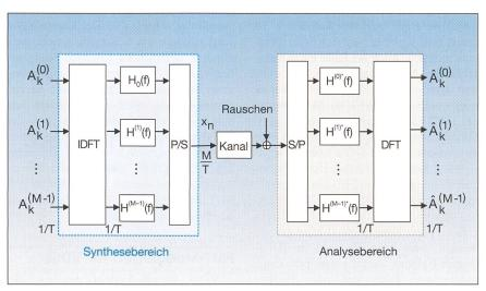
Bild 4 Eine effiziente Realisierung des Filterbanksystems aus Bild 3 für K = M mit diskreter Fouriertransformation (DFT), inverser DFT (IDFT) sowie parallel/serieller (P/S) und seriell/paralleler (S/P) Umwandlung
