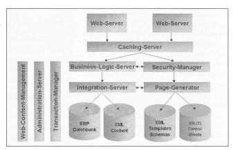
Bild 4 Komponenten einer umfassenden Web-Applikationsplattform mit XML-Technologie
