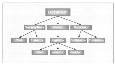
Bild 2 Baumdarstellung (DOM) eines Dokumentes mit DTD-Syntax
