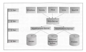
Bild 1 Die generelle 4-Stufen-Architektur für dynamische Websites
