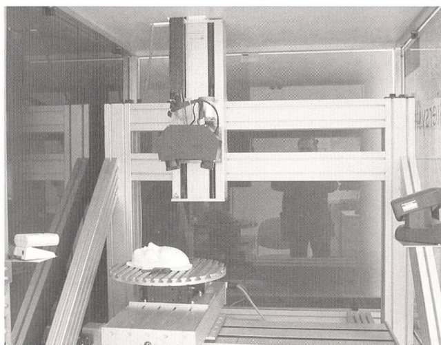
Bild 1 Versuchsaufbau für die Digitalisierung dreidimensionaler Objekte
