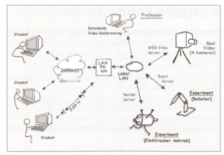
Bild 2 Kommunikationsstruktur: Der Informationsaustausch zwischen Studierenden, Professoren und den Experimenten erfolgt über interne und externe Datennetze.
