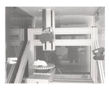
Bild 1 Versuchsaufbau für die Digitalisierung dreidimensionaler Objekte
