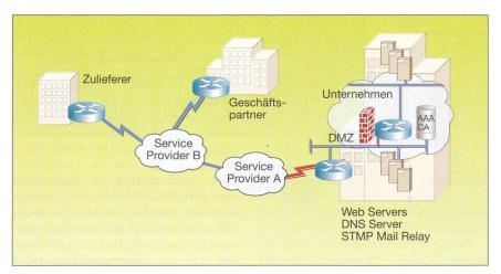
Bild 6 Extranet-VPN verbinden Dritte mit dem internen Netzwerk über ein öffentlich zugängliches Netzwerk. Quelle: Cisco Systems
