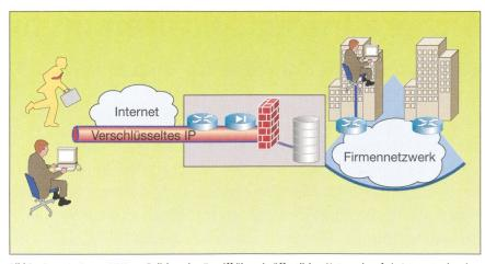
Bild 3 Remote-Access-VPN ermöglichen den Zugriff über ein öffentliches Netzwerk auf ein Intranet oder ein Extranet. Quelle: Cisco Systems
