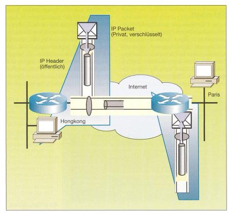
Bild 1 Prinzip des VPN. Quelle: Cisco Systems
