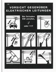
Eine Warntafel «Vorsicht gegenüber elektrischen Leitungen» in Form von Piktogrammen wurde in Zusammenarbeit mit Elektrizitätswerken erarbeitet. Sie ist für den Anschlag an elektrischen Verteilanlagen und an öffentlichen Anschlagbrettern in ländlichen Gebieten vorgesehen. Diese Warntafel hat die Grösse A3 und ist in eloxiertem Aluminium in den Farben Silber/Blau für Aussenaufstellung aus-
