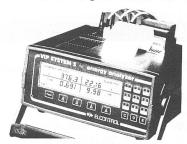
für das Messen, Registrieren und Beurteilen von Belastung, Verbrauch und Oberschwingungsgehalt elektrischer Netze
