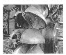
Peltonrad vor hydraulischer Prüfung.
