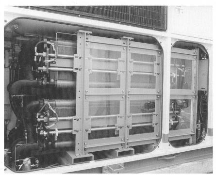
Der Stack, das Herzstück der EBM-Brennstoffzellen-Pilotanlage.
