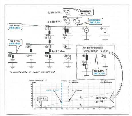
Bild 4 Rundsteuerpegel EKZ 725 Hz und EWD 600 Hz nach dem Einbau einer 75-kVar-Kompensationsanlage mit einer Verdrosselungsfrequenz von 214 Hz.
