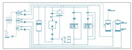
Bild 5 Prinzipschema bivalente Wärmepumpe mit Heissgasenthitzer und Flüssigkeitsunterkühler.
