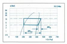
Bild 4 Kreisprozess mit 40 K Unterkühlung; Leistungszahl Verdichter:  $\Delta h_{\rm tot}$ :  $\Delta h_{\rm el}$  = 6,2.
