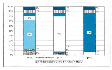
Bild 2 Aufteilung der Leistungsanteile bei verschiedenen Vorlauftemperaturen.
