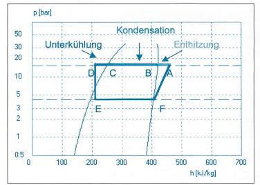
Bild 1 Darstellung von Enthitzung, Kondensation und Unterkühlung im Kreisprozess.
