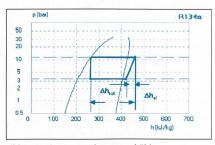
Bild 3 Kreisprozess ohne Unterkühlung; Leistungszahl Verdichter:  $\Delta h_{\rm tot}$ :  $\Delta h_{\rm el}$  = 4,7.
