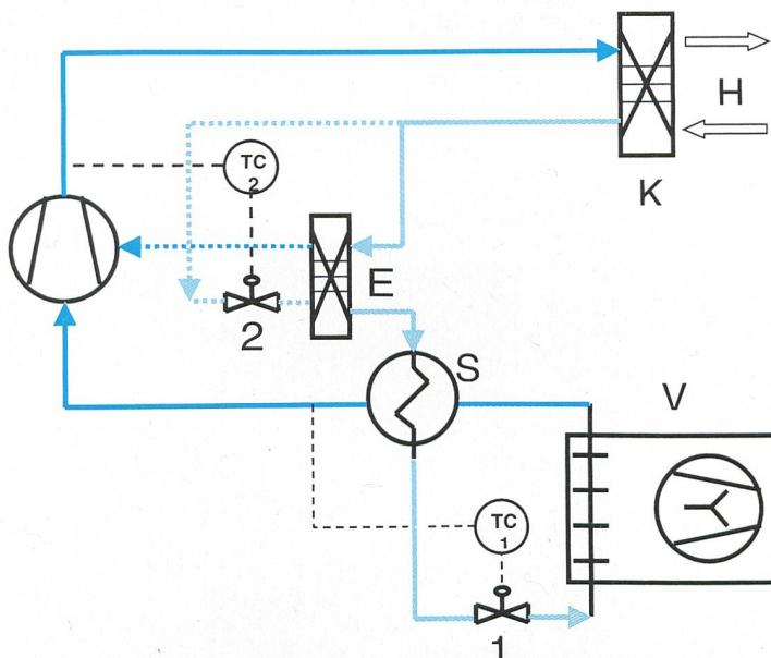
Untersuchte Prozessvariante für Wärmepumpen mit grossem Temperaturhub.
