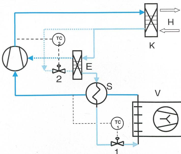
Untersuchte Prozessvariante für Wärmepumpen mit grossem Temperaturhub.
