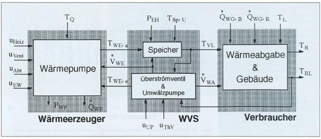
Bild 2 Signalflussbild des Gesamtsystems (WVS: Wärmeverteilsystem [5]).
