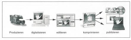
Bild 2 Produktionsschritte für Desktop-Video und Video-Streaming
