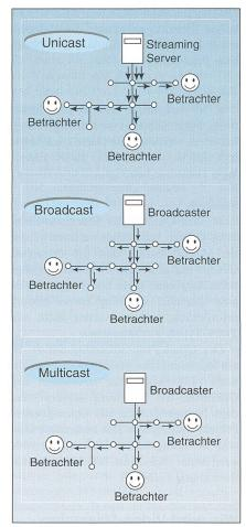
Bild 3 Unicast-, Broadcast- und Multicast-Übertragung von Streaming-Video
