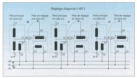
Fig. 10 Autotransformateurs et transformateurs à réglage diagonal
