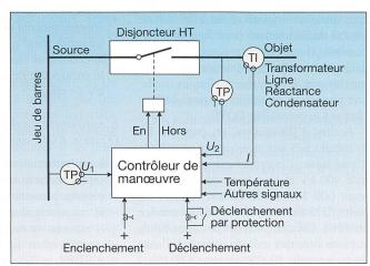
Fig. 1 Schéma de principe monophasé du contrôleur POW d'un disjonc-
