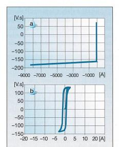
Fig. 14 Flux en fonction du courant magnétisant: enclenchement non-contrôlé (a) et flux en fonction du courant magnétisant: enclenchement contrôlé (b)
