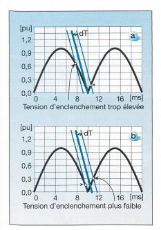
Fig. 4 Enclenchement exactement au zéro de la tension (a) et enclenchement légèrement retardé par rapport au zéro de la tension (b)
