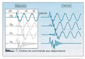
Fig. 6 Tension côté ligne (U<sub>2</sub>) lors d'un enclenchement réalisé au minimum de la tension (enclenchement contrôlé)
