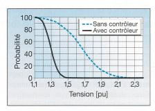
Fig. 3 Probabilité de surtensions de manœuvre avec et sans contrôleur
