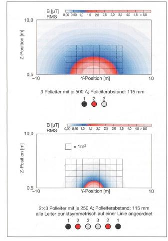
Bild 2 Feldverteilung: vertikaler Schnitt im Bereich 0,5–10 m oberhalb der Stromschienen bei einem Strom von 500 A
