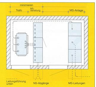
Bild 8 Beispiel einer Transformatorenstation mit optimierter Geräteanordnung
