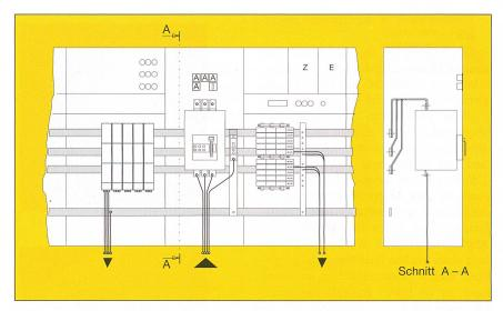
Bild 10 Beispiel einer emissionsarmen NS-Verteilung mit Mitteneinspeisung
