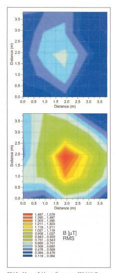
Bild 9 Magnetfeldverteilungen an 630-kVA-Transformatoren bei Nennlast in 2 m Höhe; oben optimierter, unten normaler Transformator
