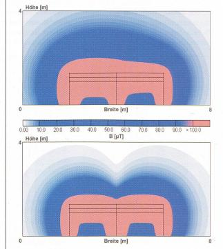
Bild 11 Magnetfeldverteilungen bei unterschiedlichen Einspeisungsstellen mit 1000 A und jeweils 500 A Abgängen; oben Seiteneinspeisung, unten Mitteneinspeisung
