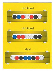
Bild 4 Ideale und nichtideale Leiteranordnungen in Kabelhaltern
