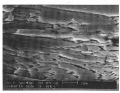
Hochtemperatur-Supraleiter unter dem Elektronenmikroskop: Korngrenzen und Hohlräume behindern den optimalen Stromfluss (Bild Universität Wuppertal).
