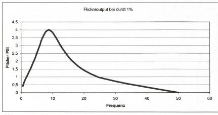
Bild 3 Frequenzverhalten eines idealen Flickermeters.
