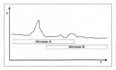
Bild 4 Unterschiedliche Messergebnisse von nicht synchronisierten Flickermetern.
