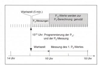
Bild 5 Das Prinzip veranschaulicht am Beispiel einer Flickermessung.
