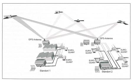
Bild 4 START: Standortübergreifende Synchronisierung der Messung aller Netzparameter.
