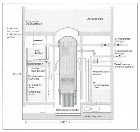
Bild 4 Sicherheitsbehälter mit Einrichtungen
