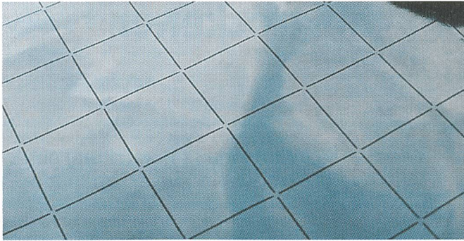
Bild 3 Beispiele für Elektrodensegmentierungen: Bei der oberen Abbildung handelt es sich um quadratische, etwa 1 cm 2 grosse Segmente, die jeweils in den Ecken elektrisch miteinander verbunden sind. Im Falle eines elektrischen Durchschlages in einem der Segmente wirkt die Verbindung als Sicherung, die verdampft, und so den Durchschlag unterbricht. Die untere Abbildung zeigt eine streifenförmige Segmentstruktur mit Verbindungen in der Mitte der Längsseite der Segmente.
