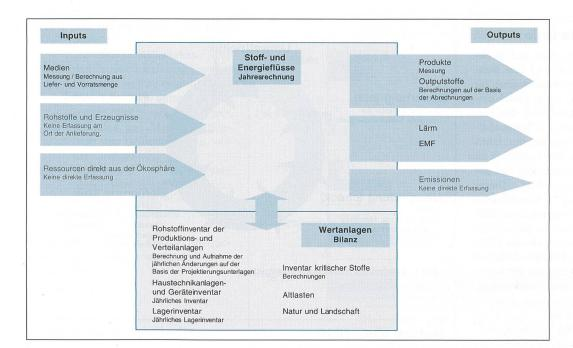
Bild 4 Sachbilanz: Input-Output-Modell der Stoffund Energieflüsse.
