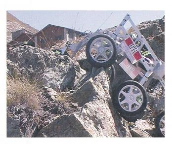
contre le bord d'une marche. Bien que le robot ait été conçu pour franchir une marche de 17 cm, il est capable de monter sur une marche de deux fois la taille de ses roues, soit 22 cm.
