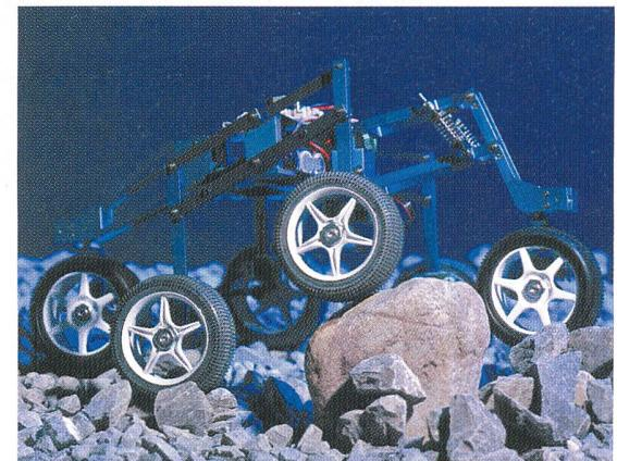
Shrimp, ein geländegängiger Roboter. Das an der ETH Lausanne entwickelte Fahrzeug eignet sich für Anwendungen auf der Erde und auf anderen Planeten.
