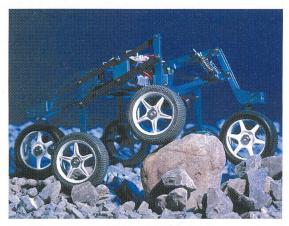
Shrimp, ein geländegängiger Roboter. Das an der ETH Lausanne entwickelte Fahrzeug eignet sich für Anwendungen auf der Erde und auf anderen Planeten.
