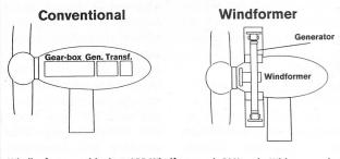
Windkraft neu positioniert: ABB-Windformer mit 20% mehr Wirkungsgrad.
