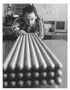
Das Herz eines SOFC-Kraftwerks: keramische Hohlröhren, die nur für Sauerstoff-Ionen durchlässig sind.
