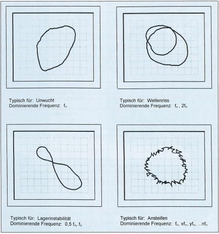
Bild 3 Rohsignale der Wellenschwingungsgeber auf dem Oszilloskop: Die von der Wellenbahn angenommene Form liefert Informationen über das Verhalten der Maschine.
