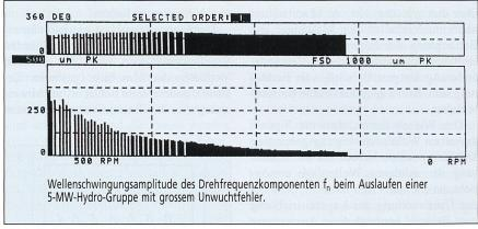
Bild 7 Bode-Diagramm beim Auslaufen.
