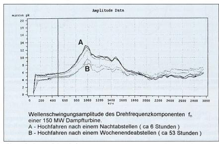
Bild 6 Bode-Diagramm beim Anlaufen.
