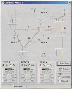
Elimination d'une surcharge (ligne 13) par un contrôle coordonné de trois FACTS.
