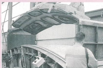
Links: Das Tübbing-Lager. Tübbinge, auf dem Platz Brunau produziert, sind Betonelemente, die zum Sichern und Abdichten des Tunnels verwendet werden. Rechts: Mit einem Vakuum-Kran wird hier ein soeben gefertigtes, 14 t schweres Tübbing-Element zur Lagerung abtransportiert.
