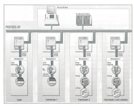
Bild 2 Anbindungen von EIB-Anwendungen an eine gebäudeübergreifende Profibus-Vernetzung
