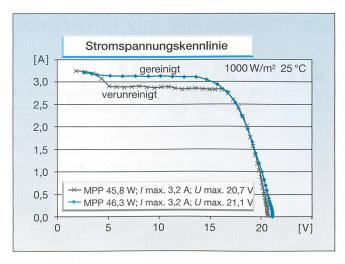
Bild 7 *I-U*-Kennlinie eines Modules, ungereinigt und nach der Reinigung
