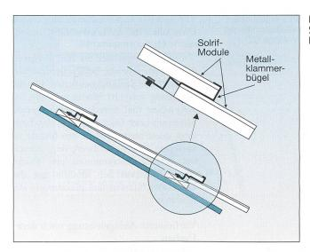
Bild 3 Solrif-Modul: Schnitt vertikal (in der Rahmenebene)
