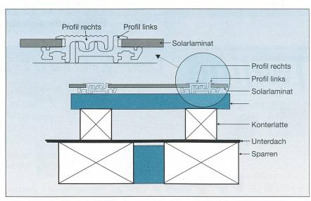
Bild 2 Solrif-Modul: Schnitt horizontal
