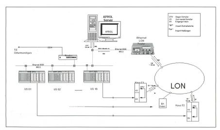
Fig. 7 Aperçu général de la domotique de Swisscom Worblaufen (Source Leicom)
