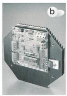
Wassertemperatur. Dieser Zustand bleibt zeitlich unverändert aufrecht erhalten, solange das Wasser nicht vollständig verdampft ist. Regelungstechnisch wird diese Tatsache für die Kochpunkterkennung beziehungsweise für die Leistungszufuhrregulierung genutzt. Der Regler erkennt an der Temperatur der Platte, wann der Kochpunkt eingetreten ist, und geht automatisch in «Fortkochen» über, ohne dass der Benutzer eingreifen muss.
