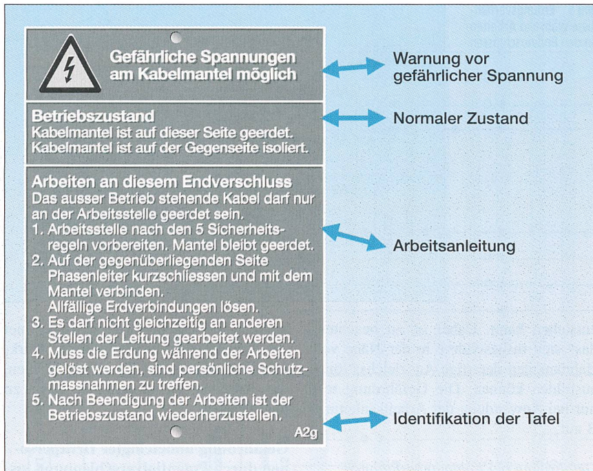
Bild 6 Warntafeln zur Verwendung bei einseitig geerdetem Kabelmantel
