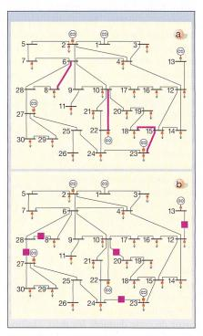
Fig. 9 Répartition de la puissance dans le réseau a) sans FACTS, b) avec 5 TCSC
