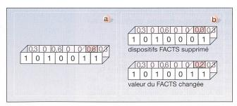
Fig. 6 Mutation au sein d'un individu: a) avant, b) après
