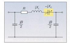
Fig. 2 Schéma d'une ligne munie d'un TCSC
