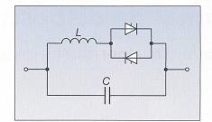
Fig. 1 Schéma de base d'un TCSC
