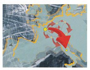
Transport elektrischer Energie von Frankreich nach Italien. Die Lastströme (rote Pfeile) werden mit Hilfe von Flexible AC Transmission Systems (FACTS) auf die direkte Verbindung zwischen Lieferanten und Abnehmer konzentriert. Dadurch kann die Übertragungskapazität der Netze gesteigert werden (siehe Artikel S. 11).
