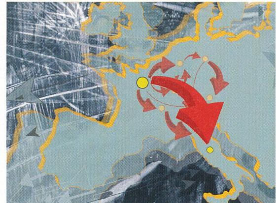
Transport elektrischer Energie von Frankreich nach Italien. Die Lastströme (rote Pfeile) werden mit Hilfe von Flexible AC Transmission Systems (FACTS) auf die direkte Verbindung zwischen Lieferanten und Abnehmer konzentriert. Dadurch kann die Übertragungskapazität der Netze gesteigert werden (siehe Artikel S. 11).
