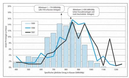
Bild 2 Die spezifischen Erträge der Photovoltaikanlagen 1999 in Kilowattstunden pro installiertes Kilowatt (kWh/kWp), aufgeteilt in 50-kWh/kWp,-Klassen. Der Mittelwert liegt bei etwa 770 kWh/kWp. Der Ertrag im 1999 war wegen ungünstiger Witterung deutlich geringer als in früheren Jahren. Zum Vergleich sind die Kurven der Vorjahre 1997 und 1998 dargestellt.
