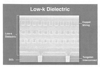
Polymere isolieren die Kupferleitungen.
