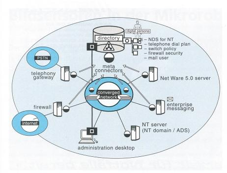
Bild 4 Netzwerkobjekte wie Benutzer und deren Eigenschaften werden in einer Datenbank mit einem Tool verwaltet.
