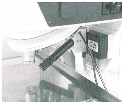
Bild 7 Integration des Lasers in das Mikroskop
