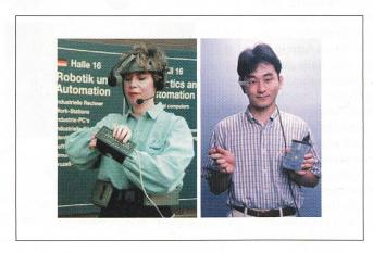
Bild 5 Beispiele heutiger Wearable-Systeme: Xybernaut-System (links) und der IBM-Wearable-Protoyp
