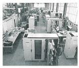
Profitieren Sie von unseren langjährigen Erfahrungen als Schaltanlagenbauer. Wir fertigen Steuerschränke jeglicher Art, bestehend aus ABB- oder Fremdprodukten. Vom Einbau einfacher Baugruppen bis zur Integration von High-Tech-Mikroprozessor-Einheiten inkl. EMV-gerechter Montage und Verdrahtung sind wir
