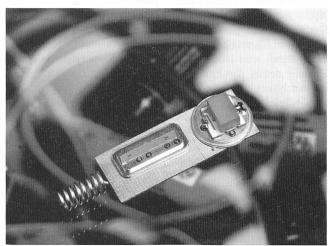
Kernstück des bei Siemens entwickelten neuen Sensors sind piezo- oder pyroelektrische Materialien, die eine elektrische Spannung abgeben, wenn man sie drückt, ihnen einen Schlag versetzt oder wenn man ihre Temperatur
