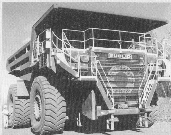
Lastwagen mit 2,2 Megawatt Antriebsleistung.
