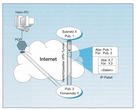
Bild 1 VPN-Szenarien mit Tunnel
