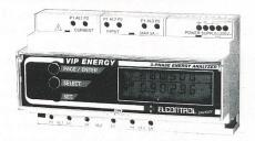
Energieanalysatoren VIP-Energy messen und registrieren genau: V, A, kW, kVar, kVA, cos-phi pro Phase + 3ph; Crestfaktor pro Phase; kWh, -kWh, kVarh, -kVarh pro Phase + 3ph; max. kW, max. kVA 3ph; Datum und Tageszeit. Strom- und Spannungswandler frei wählbar. Optionen mit RS485 Schnittstellen und Ausgangs-Impuls-Relais.
