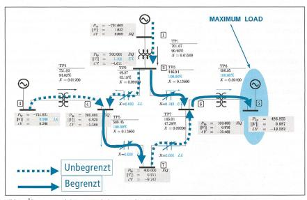
Bild 8 Übertragungsleistung-Maximierung: Mit TCSC-FACTS.
