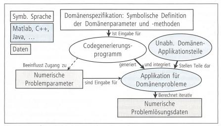
Bild 9 System-Software-Engineering: Entwicklung offener Informationssysteme.
