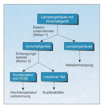
Bild 3 Vorschlag eines Wegs zur Entsorgung von Vorschaltgeräten
